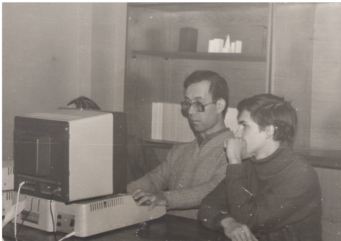
Рис. 8: Ю. В. Власов за компьютером «Правец 8» (аналог ПК «Apple II») с 8-битным процессором «Motorolla-6502». 1986 г.
